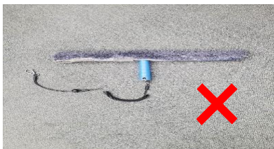
作業中に切れて地上に落下した危険な事例
