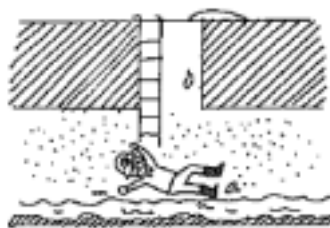
マンホール内に硫化水素滞留
