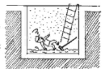
汚泥をかきまぜ硫化水素発生
