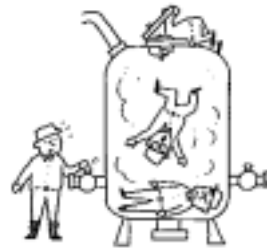
閉じた空間でガス配管のバルブを開放
