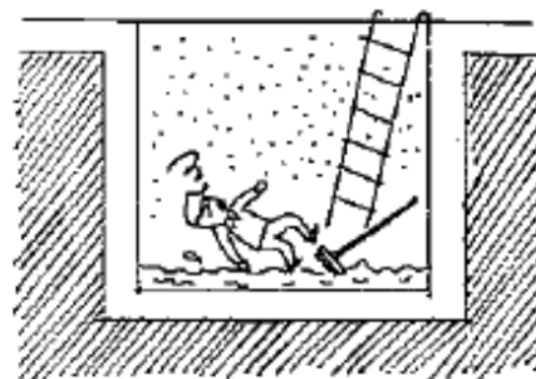
汚泥をかきまぜ硫化水素発生
