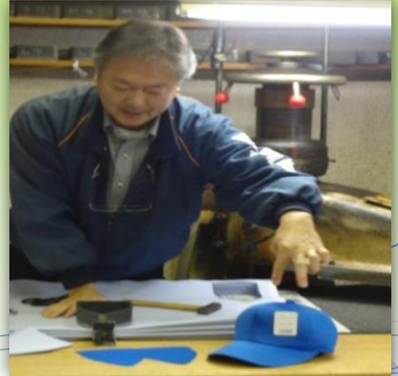
クリッカーを使用して帽子の各パーツを抜き取り、各パーツの組み合わせ方について説明がありました。裁断経験のない方もメモを取り、抜き取る前の金型の種類や、布の寸法の取り方について質問をしていました。
