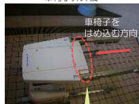
この部分に車椅子をはめ込み昇降させる
